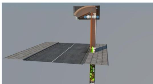
**Figura 4: Depósito subterrâneo com resíduos recicláveis pronto para coleta.**
